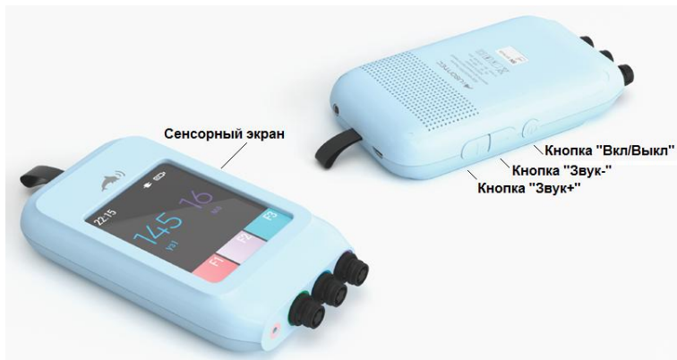
Рис. 3. Элементы управления мобильного регистратора «Илифия-Д»
